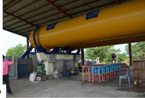
A) (Izquierda) - Sistema municipal de tipo reactor horizontal agitado de kollvik. (Derecha) Sistema municipal de tipo reactor rotativo,
