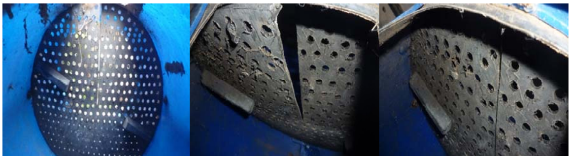
Imagen 2-4 Placas divisorias del Biodigestor Prototipo
