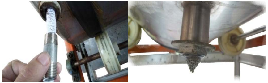
Imagen 2-12 Filtro de lixiviados
