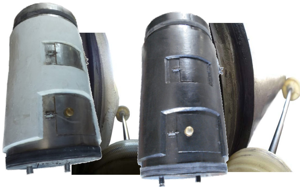
Imagen 2-13 Biorreactor con aislación térmica
