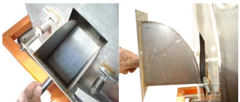
Imagen 2-11 Compuerta con pala de la 3 er cámara
