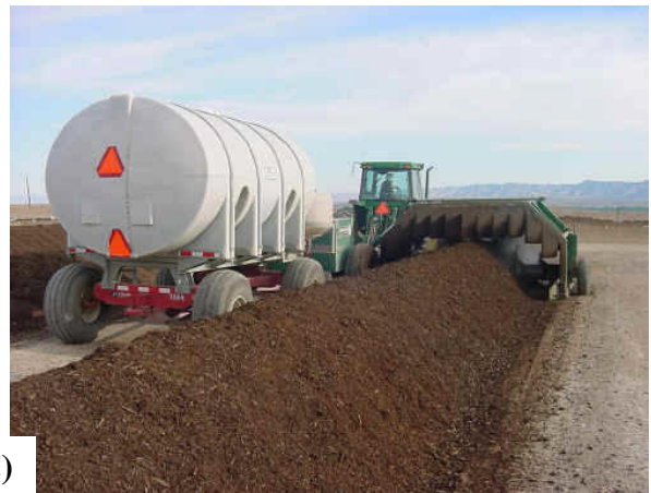
C) (Izquierda) Sistema municipal de hileras con volteo mecánico, Tauranga, Nueva Zelanda. (Derecha) Sistema municipal de hileras con volteo mecánico, Polonia
