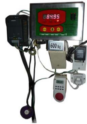
Imagen 2-16 Display de Balanza, y Control del Mecanismo de Rotación
