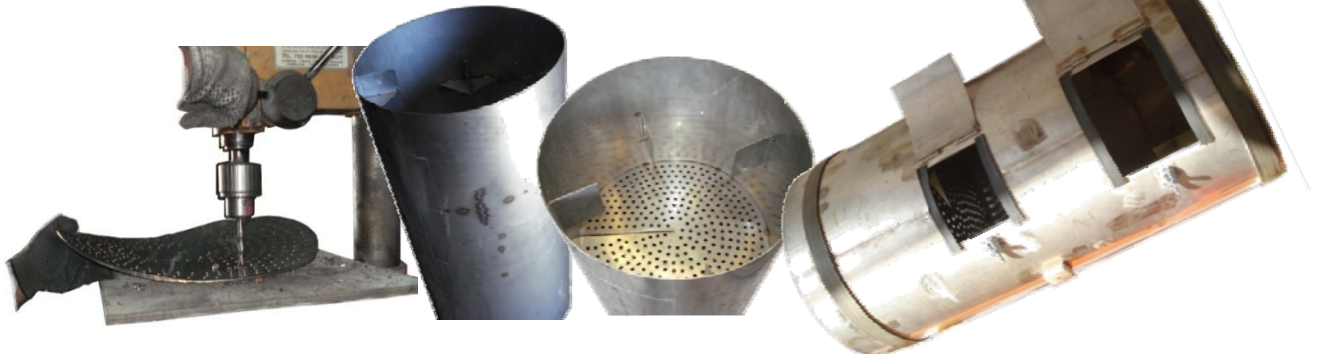
Imagen 2-8 Construcción del dispositivo
