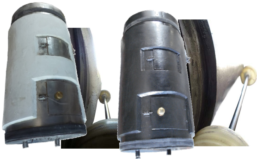
Imagen 2-13 Biorreactor con aislación térmica
