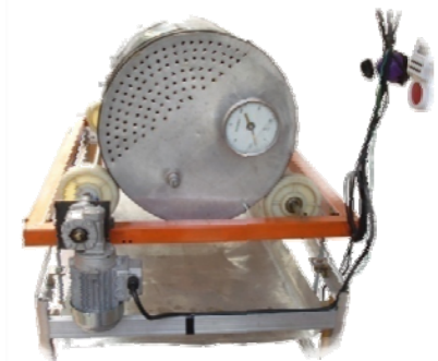
Imagen 2-15 Mecanismo de rotación Así, el sistema se puede
