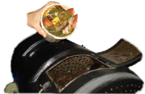
Imagen 1-8 Descarga de ROB en Biodigestor
