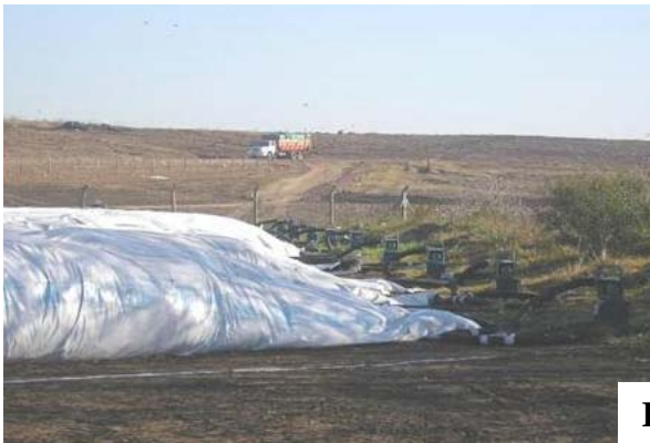
B) (Izquierda) Sistema de pila estática aireada con silo bolsa, CEAMSE Norte III, Bs.As., Argentina. (Derecha) Sistema municipal de pila estática aireada, Lewiston, EE.UU
