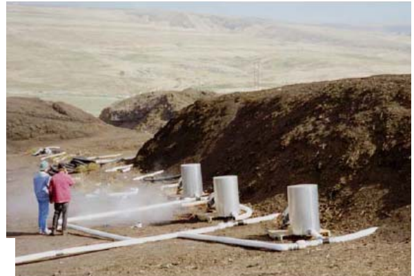
B) (Izquierda) Sistema de pila estática aireada con silo bolsa, CEAMSE Norte III, Bs.As., Argentina. (Derecha) Sistema municipal de pila estática aireada, Lewiston, EE.UU
