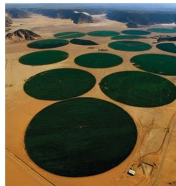
*Este carrusel de riego autopulsado taladra en busca de agua entre 30 y 400 metros por debajo de la superficie en Ma'an, Jordania. Una tubería pivotante provista de aspersores riega 78 hectáreas de tierra. La producción de una tonelada de grano requiere unas mil toneladas de agua. Al ritmo actual de consumo de agua en Jordania, las reservas de agua subterránea podrían agotarse antes de 2010*
